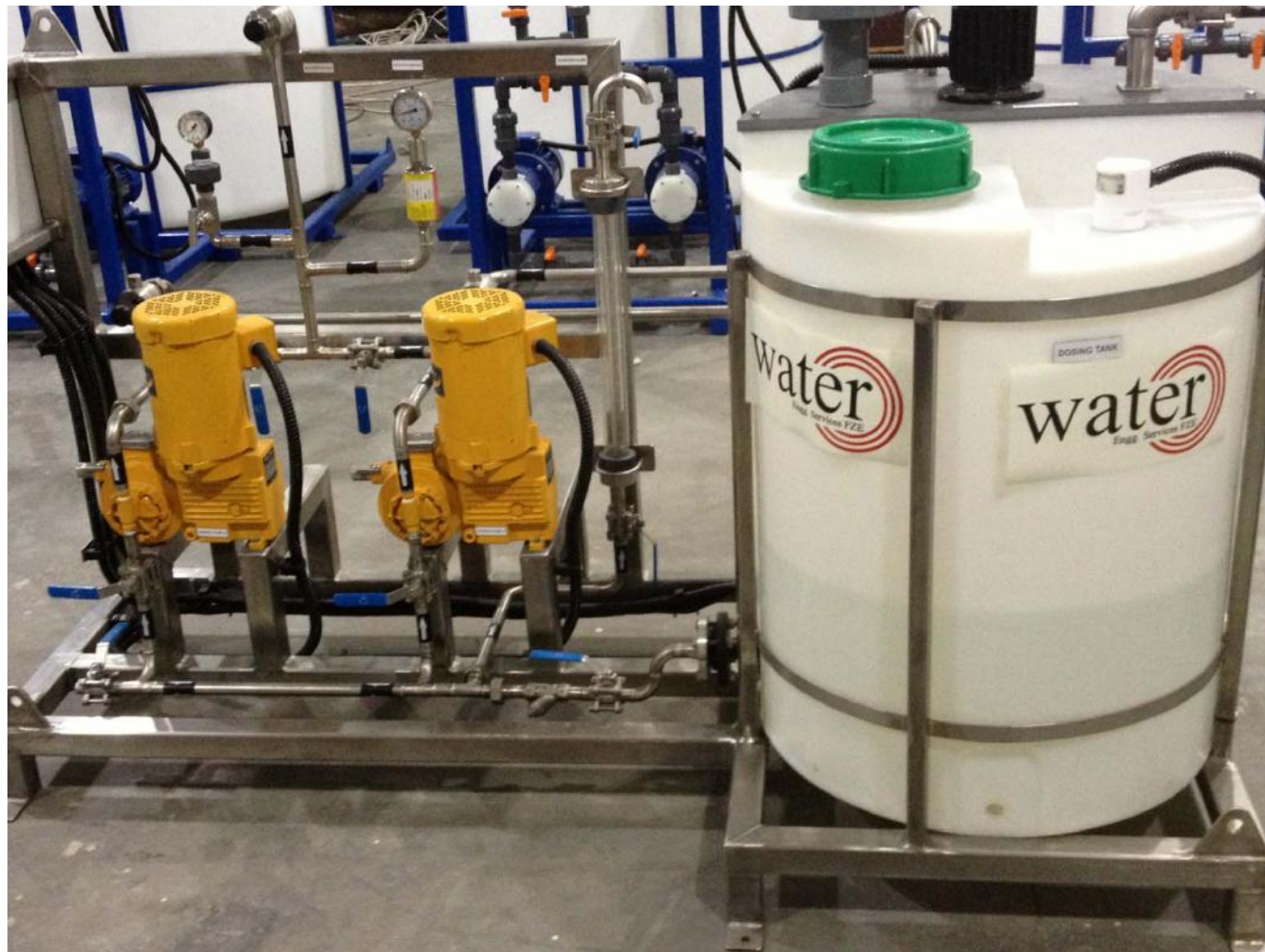
SS 316L DOSING SKID
